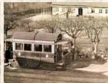
Ein von der Deutschen Gasbahn-Gesellschaft Dessau gebauter Gasmotorwagen der Hirschberger Thalbahn-Gesellschaft ergänzt im Jahre 1899 am Endpunkt der Überlandlinie in Hermsdorf seine Wasservorräte
