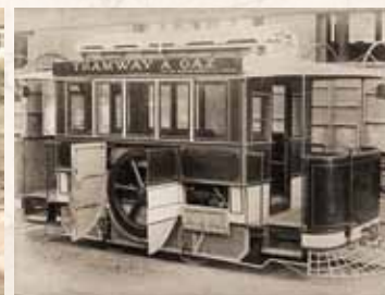
Blick durch geöffnete Wartungstüren auf die ansonsten völlig versteckte Antriebstechnik einer Gasstraßenbahn
