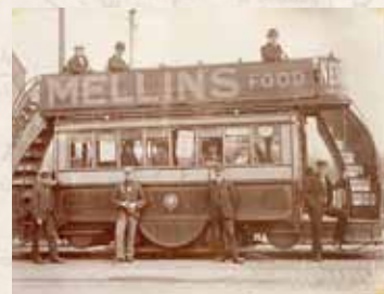
Einer der größten je gebauten Gasmotorwagen mit 52 Sitzplätzen steht um das Jahr 1900 abfahrbereit am Linienendpunkt des Badeortes Blackpool
