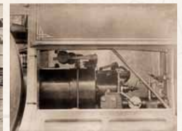
Blick auf einen der beiden Motorzylinder des in einen Gasmotorwagen eingebauten 4-Takt-Otto-Motors und das elektromagnetische Zündsystem
