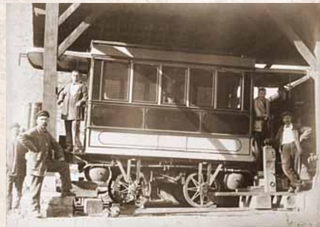
Ein in den Dresdner Werkstätten der „Gas Traction Company, Ltd.“ gebauter Gasmotorwagen wird im Herbst 1895 zu Reparaturzwecken aufgebockt, was einen Blick auf die unter dem Wagen verbaute Gastechnik erlaubt.
