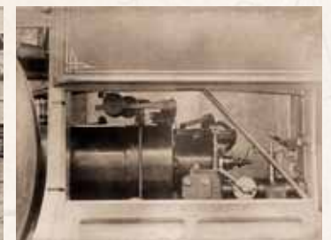
Blick auf einen der beiden Motorzylinder des in einen Gasmotorwagen eingebauten 4-Takt-Otto-Motors und das elektromagnetische Zündsystem
